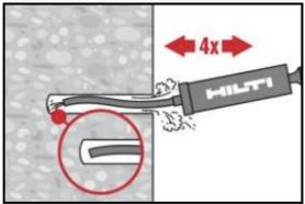
La pompe manuelle Hilti peut être utilisée pour nettoyer les trous de perçage jusqu'à des diamètres  $d_0 \leq 20$  mm et des profondeurs de trou de perçage  $h_0 \leq 10 \cdot d$ . Soufflez au moins 4 fois depuis l'arrière du trou de perçage jusqu'à ce que le flux d'air de retour soit exempt de poussière notable.
