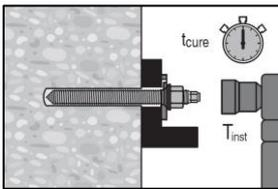
Après le temps de durcissement requis  $t_{cure}$  (voir Tableau B2), la fixation peut être chargée. Le couple de serrage d'installation appliqué ne doit pas dépasser les valeurs max.  $T_{inst}$  données dans le Tableau B1.
