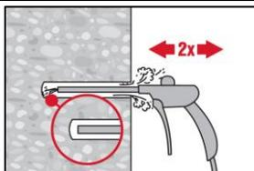
Soufflez à nouveau avec de l'air comprimé 2 fois jusqu'à ce que le flux d'air de retour soit exempt de poussière notable.
