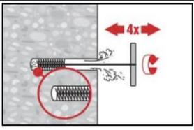
Brossez 4 fois avec la brosse spécifiée (voir Tableau B3) en insérant la brosse en acier Hilti HIT-RB à l'arrière du trou (si nécessaire avec une extension) en effectuant un mouvement de rotation, puis retirez-la. La brosse doit rencontrer une résistance naturelle lorsqu'elle pénètre dans le trou de perçage (diamètre de la brosse  $\phi \geq$  diamètre du trou de perçage  $\phi$ ) - sinon, cela signifie que la brosse est trop petite et doit être remplacée par le diamètre approprié.
