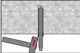
Pour une installation au plafond, utilisez des embouts piston et fixez les éléments de fixation avec, par exemple, des coins.
