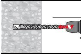
Percez le trou jusqu'à la profondeur d'ancrage requise avec une perceuse à percussion réglée en mode rotation-percussion à l'aide d'un foret en carbure de taille appropriée.
