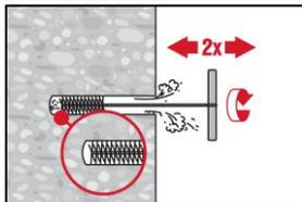
Brossez 2 fois avec la brosse spécifiée (voir Tableau B3) en insérant la brosse en acier Hilti HIT-RB à l'arrière du trou (si nécessaire avec une extension) en effectuant un mouvement de rotation, puis retirez-la. La brosse doit rencontrer une résistance naturelle lorsqu'elle pénètre dans le trou de perçage (diamètre de la brosse  $\phi \geq$  diamètre du trou de perçage  $\phi$ ) - sinon, cela signifie que la brosse est trop petite et doit être remplacée par le diamètre approprié.
