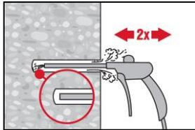
Soufflez 2 fois depuis l'arrière du trou (si nécessaire avec une rallonge de buse) sur toute la longueur avec de l'air comprimé exempt d'huile (minimum 6 bars à 6 m<sup>3</sup>/h) jusqu'à ce que le flux d'air de retour soit exempt de poussière notable. Pour les diamètres de trous de perçage  $\geq 32$  mm, le compresseur doit fournir un débit d'air minimum de 140 m<sup>3</sup>/h.
