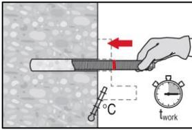
Avant utilisation, vérifiez que l'élément en acier est sec et exempt d'huile et d'autres contaminants. Marquez et placez l'élément en acier à la profondeur d'ancrage requise avant que le temps de travail  $t_{work}$  ne se soit écoulé. Le temps de travail  $t_{work}$  est donné dans le Tableau B2.
