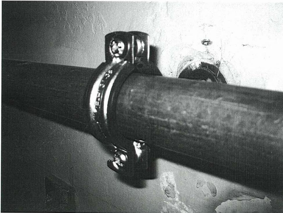
Bild 3: Prüfaufbau, Bezugsmessung, starre Befestigung mit Hilti MPN 29-32 ohne Einlage
