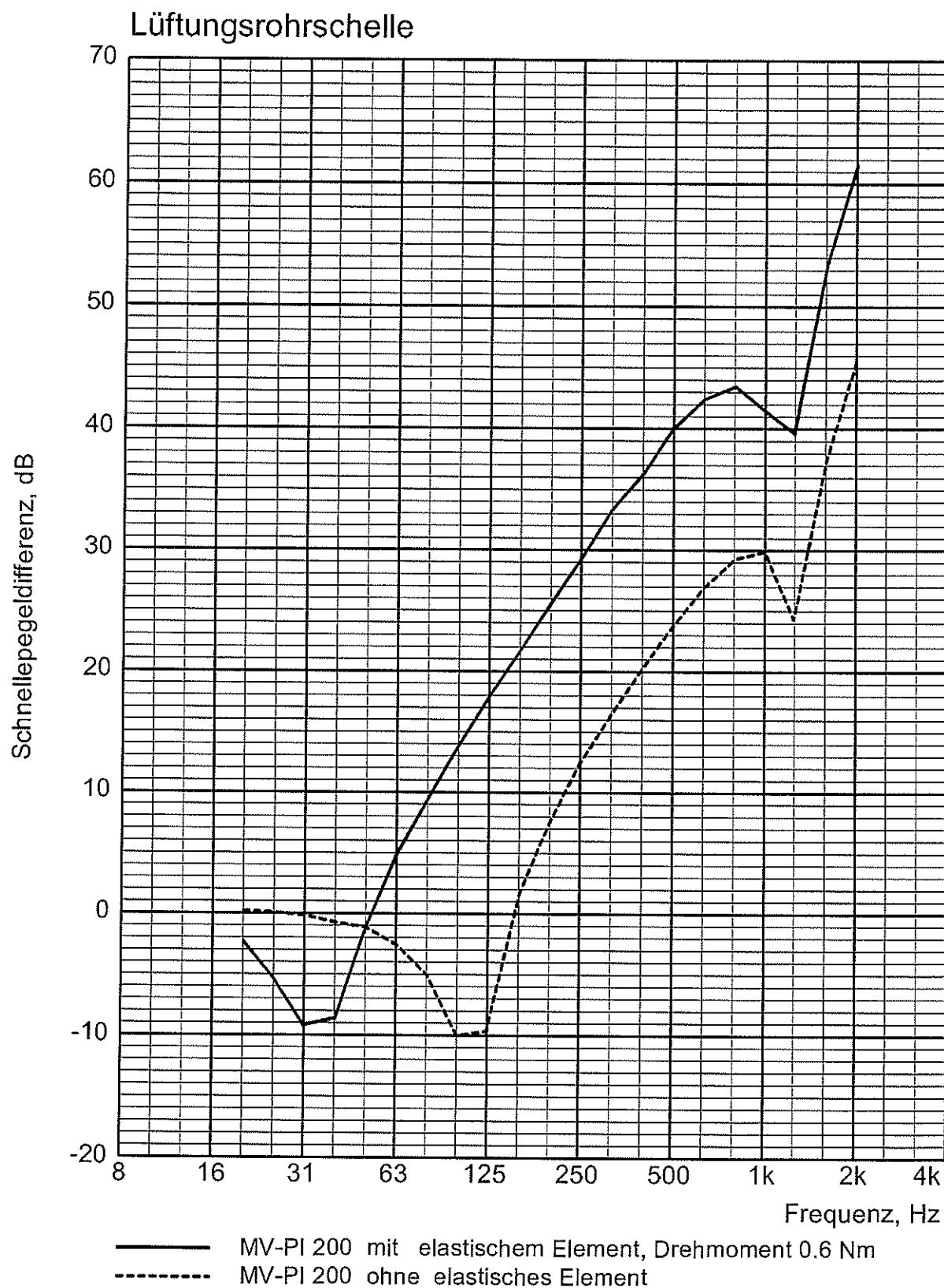
**Ermittlung der Körperschalldämmung
