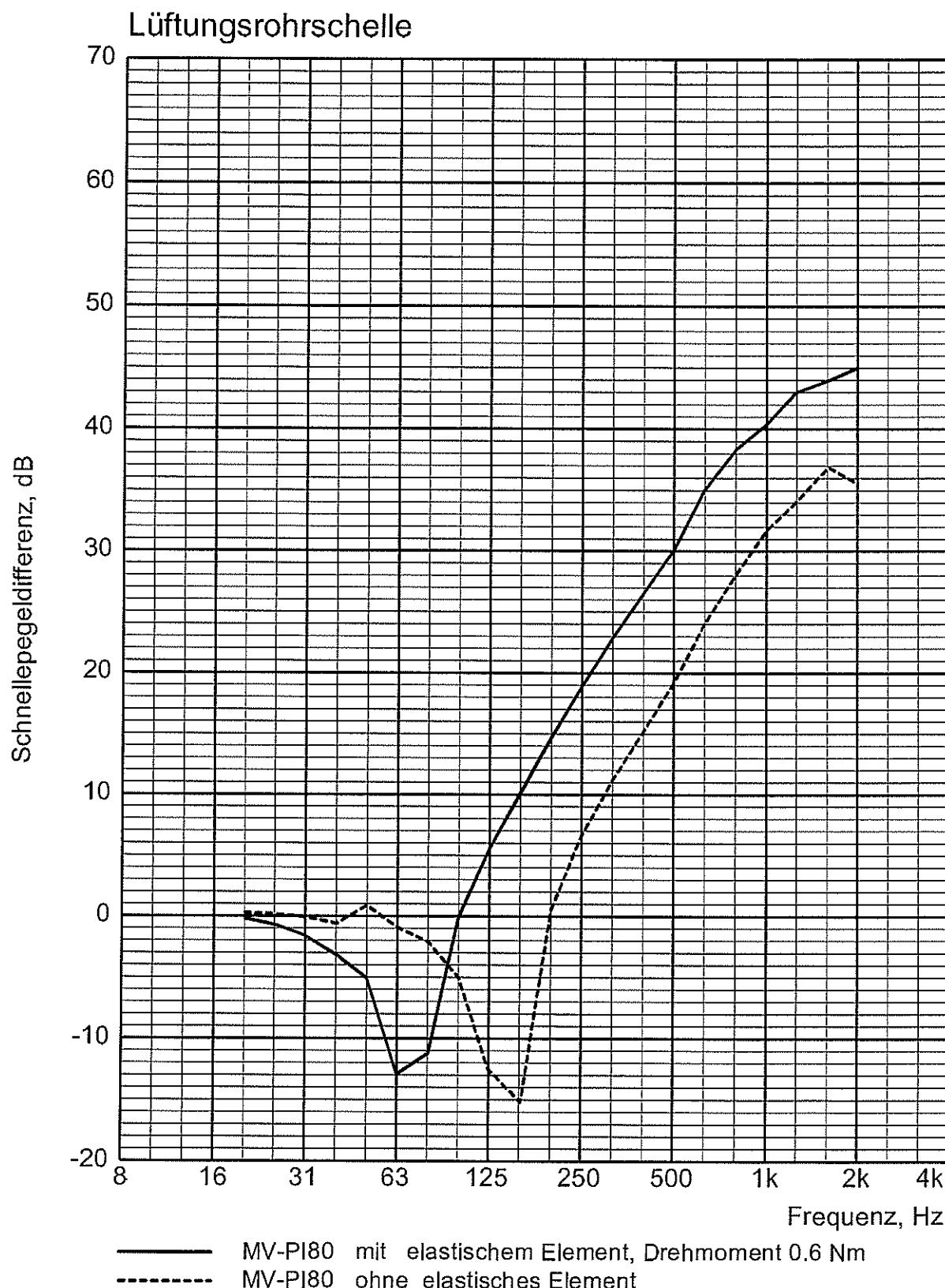
**Ermittlung der Körperschalldämmung
