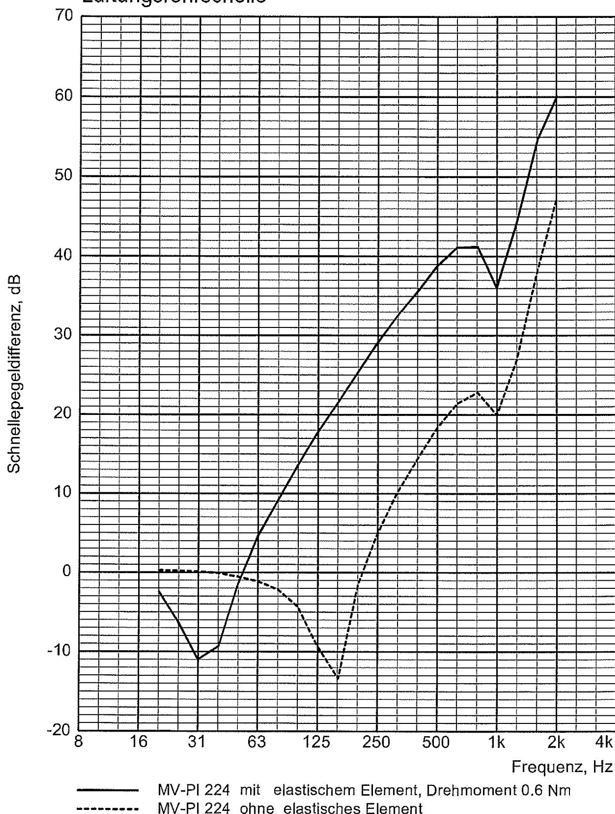
**Ermittlung der Körperschalldämmung
