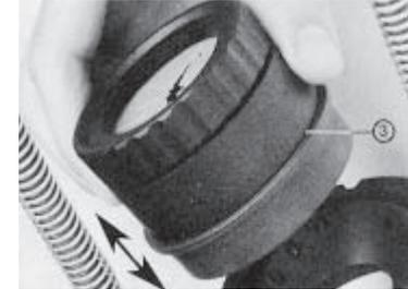
Wasserfangring (3) aufsetzen und fest in die Halterung drücken. Wasserentsorgungsschlauch anschliessen.
