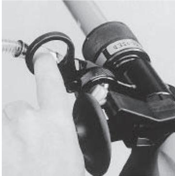
Régler le robinet d'arrivée d'eau avec l'index.
