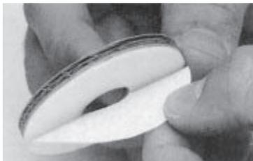
Ce disque sert au prépointage lors du fonctionnement à sec. Pour chaque diamètre de couronne de forage, utiliser le disque correspondant. Coller le disque de centrage à l'endroit où vous avez prévu de forer en enlevant la pellicule de protection ou le clouer (s'il ne peut être collé). N'utiliser et ne coller le disque de centrage qu'une fois.
