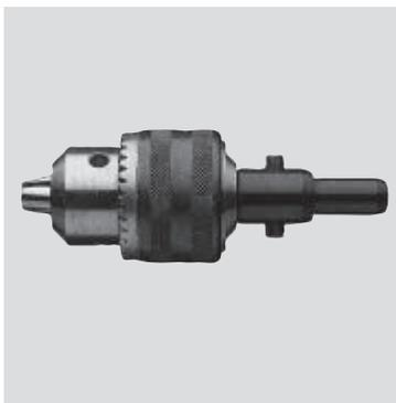
Pour insérer un outil cylindrique ou un outil à 3 ou 6 pans (13 mm ou 1/2"), ouvrir le mandrin au diamètre nécessaire. Enfoncer l'outil à fond, fermer le mandrin avec la clé.
