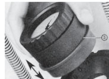
Placer le collecteur d'eau (3) dessus et l'enfoncer solidement dans le support. Brancher le tuyau flexible d'élimination d'eau.
