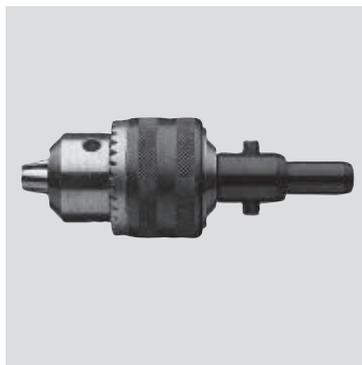
轉開夾頭至所需開口大小，裝入直柄鑽頭，3面或六角形柄（13mm或1/2"）的鑽頭，推到底，然後使用提供的扳手將夾頭旋緊。
