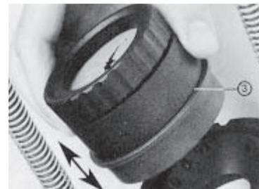
選擇適合鑽頭直徑的中心環（①）置入環座（②）中，插入集水器（③），同時向下壓，使固定於集水器固定座上，接上排水管。
