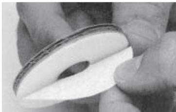
乾式鑽孔用起動鑽孔輔助器：針對鑽頭直徑使用適當的中心片，撕掉保護箔，將塗有自黏性的中心片黏在要鑽的孔位置上。如果黏性不足時可用釘子，具自黏性的中心片只能使用一次。
