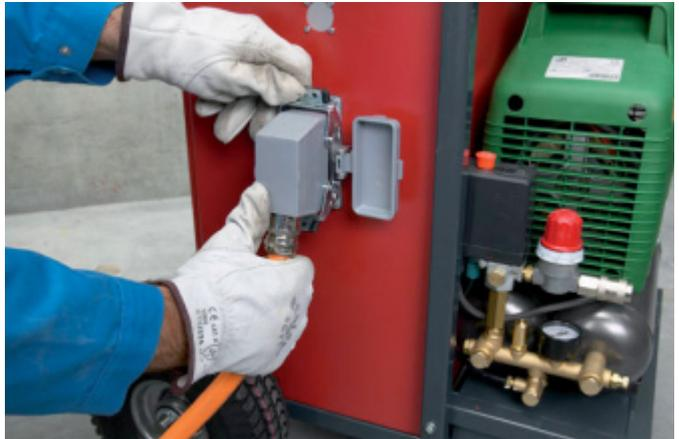
Powerkabel anschliessen und Stecker verriegeln (DS WS10-E).
