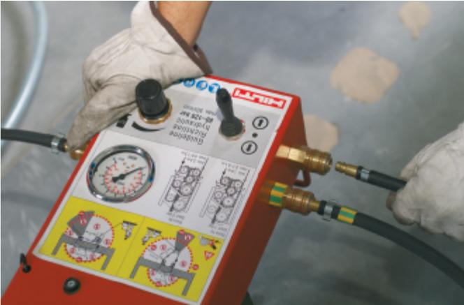
Pressluftleitungen an Kompressor und Steuerkasten anschliessen (DS WS10).
