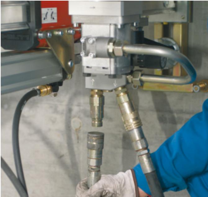
Hydraulikleitungen am Antrieb anschliessen (DS WS10).
