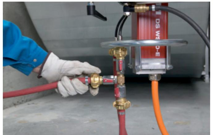
Wasseranschluss an Antriebseinheit anschliessen (DS WS10-E).
