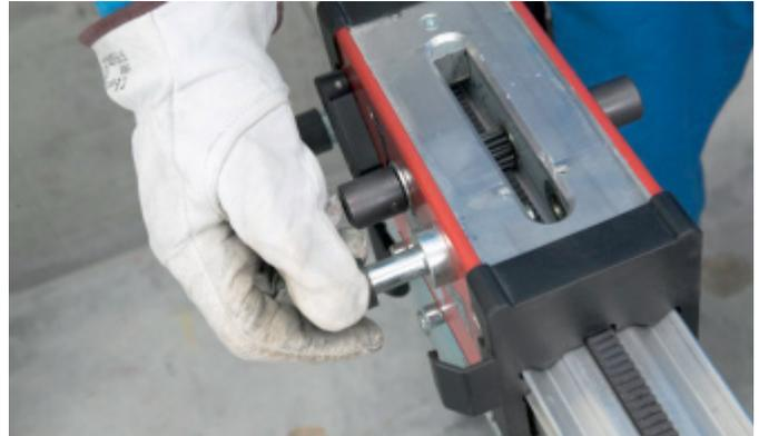
Klemmbolzen am Führungsgehäuse herausziehen.
