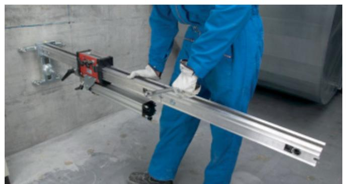
Speichererweiterung aufsetzen und mit Exzenterbolzen klemmen.
