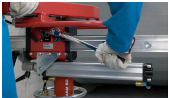
Klemmbolzen einschieben im Uhrzeigersinn festdrehen und Endanschlag aufsetzen.
