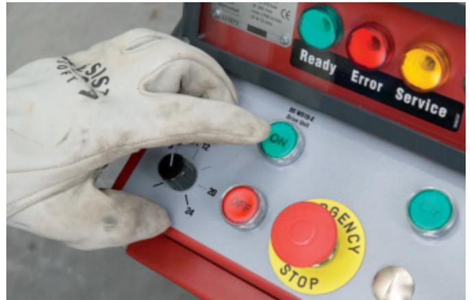
Schalten Sie den Hauptantrieb DS WS10-E ein und lassen Sie das Sägeseil anlaufen.
