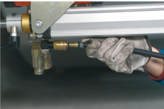
Pressluftleitungen an Druckluftzylinder anschliessen.
