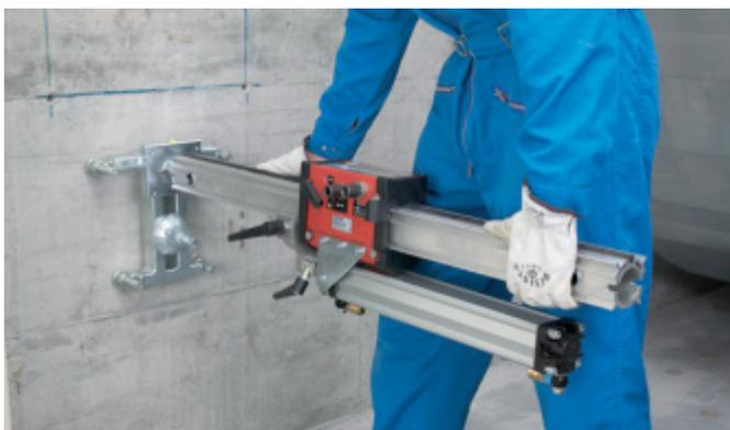
Aufnahmekonus in Führungsschiene einführen und Exzenterbolzen ganz einstecken.
