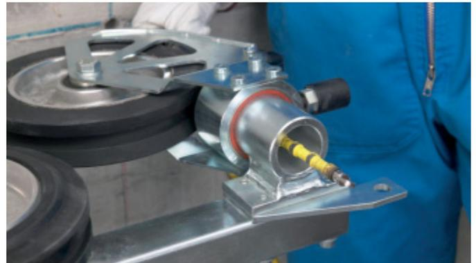
Führen Sie das Seil anschliessend durch die Hohlräume der Rollenständer (wenn verwendet) und danach durch die Hohlräume des Rollenträgers an der Kleinsägesäge. Um eine gleichmässig runde Abnutzung des Sägesegels zu erzielen empfehlen wir Ihnen diese vor dem Verbinden ca. 0,5 mal je Meter Seillänge entgegen dem Uhrzeigersinn einzudrehen.
