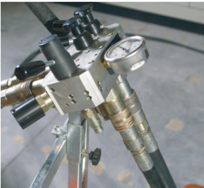
Hydraulikleitungen an Ventilblock/Hydraulikaggregat anschliessen (D-LP15 / D-RC22 oder D-LP32).
