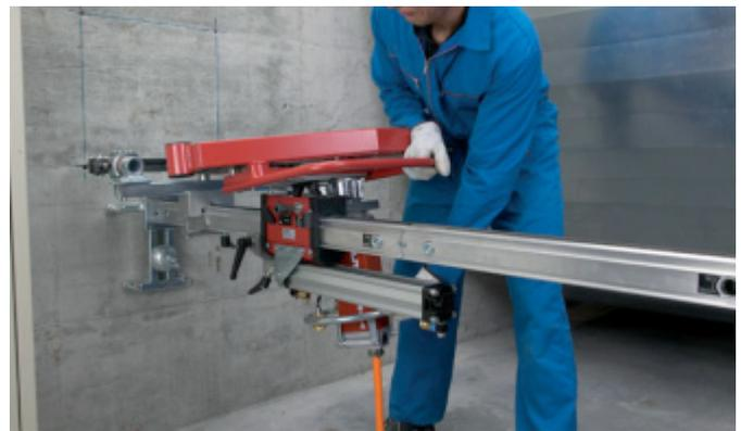
Spannhacken in Führungsschlitz einführen.
