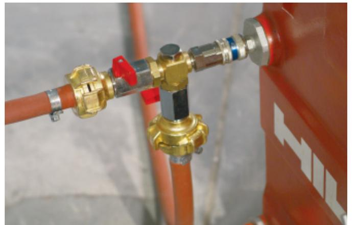
Wasserverteiler an Hydraulikaggregat montieren (DS WS10).
