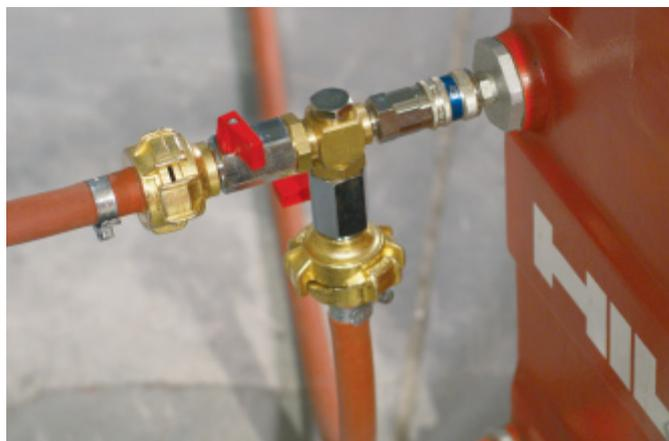
Подсоедините тройник к гидравлическому агрегату (DS WS10).
