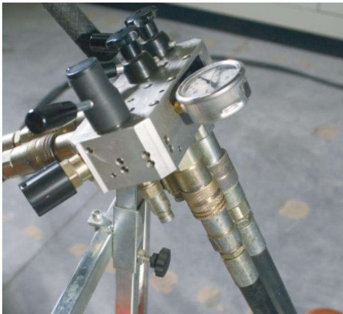
Подсоедините гидравлические шланги к узлу клапанов / гидравлическому агрегату (D-LP15 / D-RC22 или D-LP 32).
