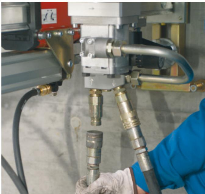
Подсоедините гидравлические шланги к узлу привода (DS WS10).
