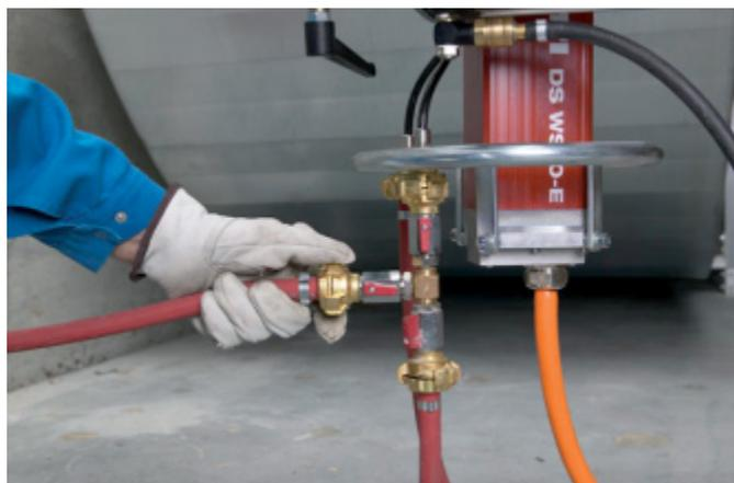
Подсоедините тройник к узлу привода (DS WS10-E).
