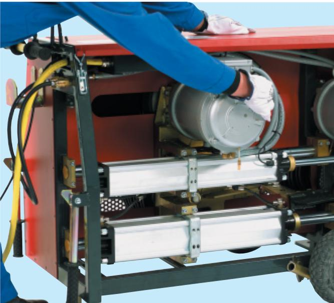
■ Lo ideal sería que el cable se dispusiera en el sistema de accionamiento sólo con la disposición básica de al menos 3,2 m. Así se puede serrar el espesor máximo del elemento de construcción correspondiente sin intervenir en el cable. No obstante, también se puede arrancar con el almacenador totalmente ocupado.
