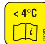
Para evitar daños, si existe riesgo de congelación, el circuito de refrigeración del sistema debe ser purgado con aire comprimido después de su uso.
