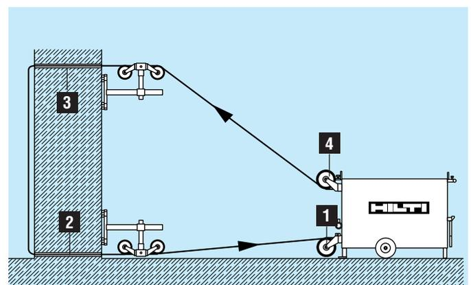
**Importante:** Recomendamos a los operarios que, en este momento, como muy tarde, antes de unir ambos extremos del cable, introduzca el cable en el sistema de accionamiento deslizándolo suavemente con la mano hacia adelante y hacia atrás. Así queda asegurado que las guías del cable están bien ajustadas al elemento de construcción y que el proceso de serrado se desarrolla correctamente.
