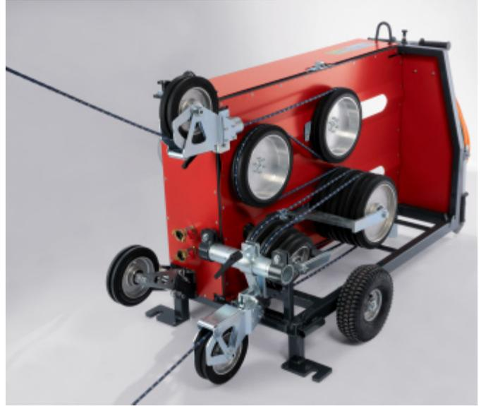
■ Lleve con la mano el motor propulsor sobre el carro hasta la posición deseada. Para ello las dos conexiones de aire comprimido de la parte trasera del sistema de accionamiento tienen que estar conectadas, o bien estar unidas entre sí (para que el aire pueda circular en los cilindros de aire comprimido).
