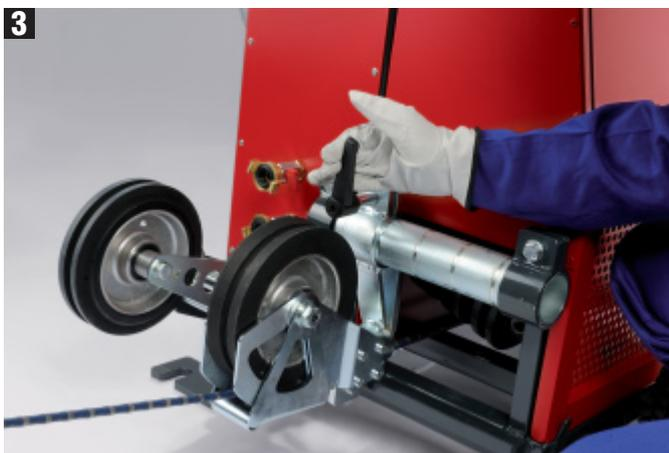
■ Controle todo el proceso de circulación del cable; vuelva a enganchar los tramos de cable que se hayan podido caer de las ruedas guía. Fíjese en la alineación
