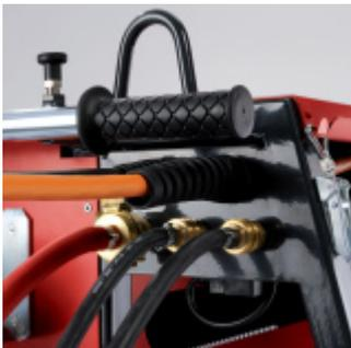
Conexión de agua hacia el sistema de accionamiento
