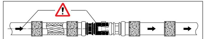
■ El cable que viene desde el elemento de construcción en la dirección de tracción siempre se introduce en el sistema de accionamiento por las ruedas guía inferiores o por el eje hueco inferior.
