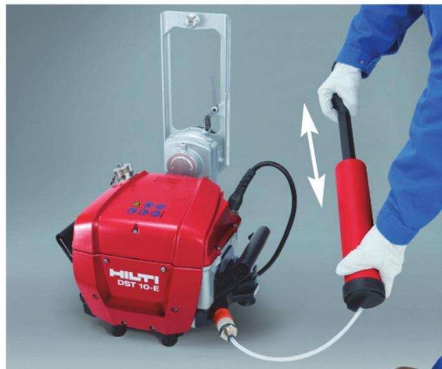
1. Inserire l'adattatore per il soffiaggio sul tubo flessibile della pompa.
