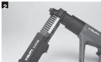
Nagelstreifen ins Elementemagazin einlegen. Magazin vollständig schliessen. Kartuschenstreifen einführen.
