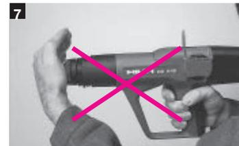
**Vorsicht: Bolzenführung nie mit der Handfläche oder über das Verbindungselement (z.B. X-IE) zurückdrücken; Verletzungsgefahr!**
