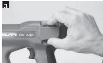
3 Geräteleistung einstellen durch Drücken und Drehen des Einstellrades 1 = min. Leistung 4 = max. Leistung Mit minimaler Leistung beginnen. Wird das Befestigungselement nicht weit genug eingetrieben, Leistung erhöhen.
