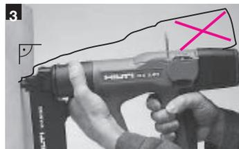
Befestigen: Gerät rechtwinklig zur Befestigungsebene, ansetzen, anpressen und anschliessend Abzug betätigen.
