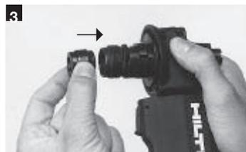
Kolben bis zum Anschlag ins Gerät stecken. Puffer auf Bolzenführung oder Magazin stecken.
