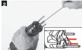
Stirnseitige Bohrungen in Kartuschen-lager(2 Stück) mit kleiner Bürste reinigen. Abgaskolbenrückführung aussen reinigen und leicht mit Hilti Spray einsprühen.
