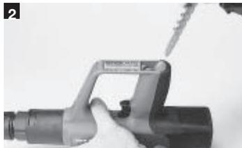
2 Kartuschenstreifen mit schmalem Ende voran von unten in den Griff stecken bis der Streifen vollständig im Griff versenkt ist. Ist der Kartuschenstreifen bereits gebraucht, Streifen von Hand solange nachziehen bis sich eine volle Kartusche im Kartuschenlager befindet.
