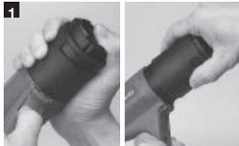
Druckknopf am Griffbügel entriegeln und Abgaskolbenrückführung abschrauben.
