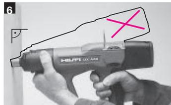
6 Befestigen: Gerät rechtwinklig zur Befestigungsebene, ansetzen, anpressen und anschliessend Abzug betätigen.
