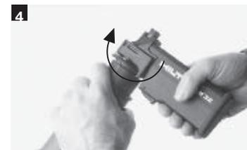
Bolzenführung oder Magazin fest auf die Kolbenführung drücken und aufschrauben, bis sie einrasten.
