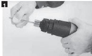
1 Kartuschenstreifen aus Gerät ziehen. Nach längerem Transport oder Erschütterung: Mit dem beigelegten Einstosser überprüfen, ob der Kolben in rückwärtiger Stellung ist.
