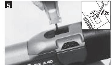
Rechten und linken Kartuschenstreifenkanal mit beigelegtem Schaber von oben 2 mal reinigen.
