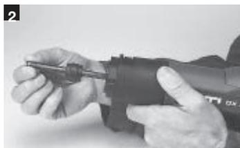
Kolben mit Puffer aus dem Gerät ziehen. Der Puffer dient zum Abbau von Überenergie im Gerät und muss bei Verschleisserscheinungen (Verformungen, Ausfransungen) gewechselt werden. Klemmt der Kolben in der Bolzenführung, muss die ganze Abgaskolbenrückführung entriegelt und abgeschraubt werden (siehe Abschnitt Pflege und Wartung). Kolben anschliessend mit beigelegtem Einstosser durch Kartuschenlager ausstossen.
