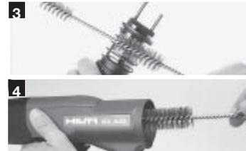
Feder reinigen und einsprühen. Gehäuse innen reinigen.
