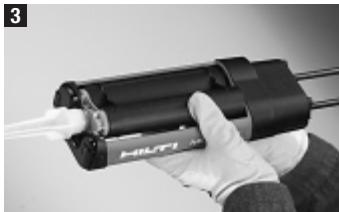
Avant d'insérer le porte-cartouches dans le pistolet à injecter, il est nécessaire de reculer à fond les tiges-poussoirs (1) tout en actionnant le bouton de déverrouillage (2). (Voir fig. 8)
