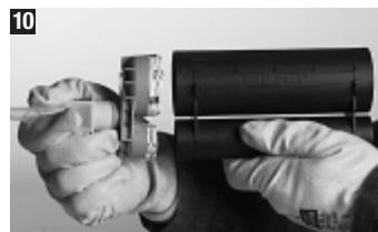
Opróżniony ładunek należy ususzyć z dozownika. Kasetka nadaje się do ponownego, wielokrotnego użycia.
