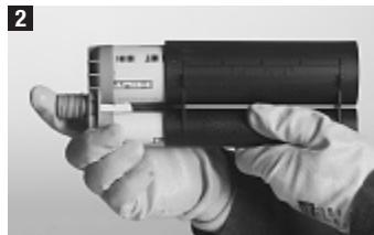
För in folieförpackningen (7) tills stopp i kassetten (6) och skruva på blandningsrör (8 eller 9).
