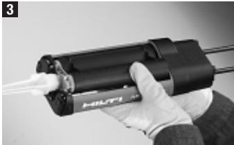
Πριν τοποθετηθείτε τον συγκρατητήρα στο εργαλείο, οι αξονες πιεσης πρέπει να τραβήχτουν εξω, στο τελευταιο σημειο καθως πιεζέτε τον μοχλο απελευθερωσής(2). Βλεπε φωτ. 8. Πιαστε τον συγκρατητήρα απο τον μικρο κυλινδρο. Τοποθετηστε τον συγκρατητήρα στο εργαλειο απο επανω και μετα πιεστε τον μικρο κυλινδρο να μπει στην σωση θεση.
