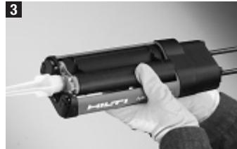
Прежде чем вставить кассету в пистолет, оттяните двойной поршень (1) до конца назад, нажимая на рычаг для снятия давления (2). См. фото 8.
