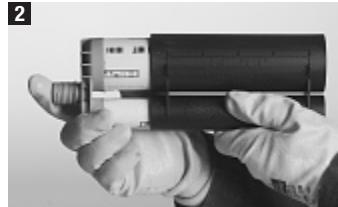
Das Foliengebinde (7) bis zum Anschlag in die Kassette (6) einführen und anschliessend den Statikmischer (8 oder 9) aufschrauben.
