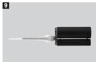
未用完的藥劑包，旋上混合嘴放在灌注筒內存放。而在混合嘴內的藥劑經一段時間之後會硬化掉，如要繼續使用未用完的藥劑包之前必須更換混合嘴。
