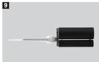
Avatut patruunat säilytetään sekoituskärki kiinnitetynä kasetissa. Jos työ keskeytty piitemäksi ajaksi, sekoituskärjessä oleva massa kovettuu. **Tällöin sekoituskärki on vaihdettava, ennen kuin työ aloitetaan uudelleen. Huom!** Avatut patruunat on käytettävä neljän viikon kuluessa.
