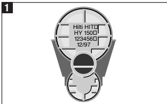
Antes de usar, ler as indicações de segurança e condições de uso dadas nas instruções contidas na embalagem de metal (7). Verificar a data de validade e observar a designação do produto impresso na frente da embalagem de metal na peça de junção. Para qualquer reclamação por favor indicar o número do lote.
