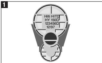
A fóliatubus (7) felhasználása előtt kérjük figyelmesen olvassa el a mellékelt használati utasításban leírt biztonsági utasításokat és alkalmazási feltételeket. A fóliatubus összekötő fedélénél előlapján olvasható a termék megnevezése és a felhasználhatóság dátuma. A gyártási szám reklamáció esetén szükséges.
