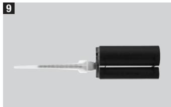
部分的に使用したフォイルパックは、ミキシングノズルを付けたままでホルダー内に保管しなければなりません。長い間隔があくと、ミキシングノズル内の樹脂は硬化します。ミキシングノズルは作業再開前に必ず交換して下さい。
