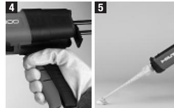
扳動扳機(4)錫箔包藥劑可由藥劑包連接端上的尖頭自動刺開，當兩種藥劑經過混合嘴即可看得到在混合。當藥劑包打開之後(剛流出的藥劑)在最初扳動兩下扳機所打出的藥劑須丟棄，並不適合使用。同樣的，在更換混合嘴之後，最初流出的藥劑亦須丟棄(如圖5)，扳動扳機須盡可能的扳到底。
