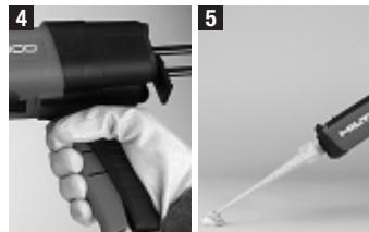
Tryck in matningsreglage (4). Folieförpackningen öppnas automatiskt. I blandningsröret syns hur de båda komponenterna blandas.
