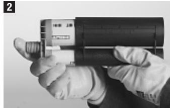
Вставьте полиэтиленовую капсулу (7) в кассету до упора, затем поверните носик для перемешивания (8 или 9).
