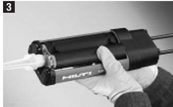
Holderen med foliepakken legges inn i apparatet, stempelstangen (1) løsnes ut med utløseren (2) og trekkes tilbake. (Se bilde 8).
