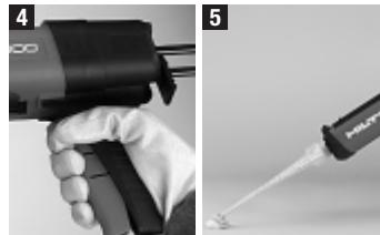
A (4) adagolóbillentyű hátrahúzzuk. A két komponens összekötő elemében található tüske a nyomás következtében felszakítja a tubusokat. A két komponens látható módon keveredik össze a keverőszárban. Az első néhány meghúzásnál a keverédes még nem teszi alkalmassá a habarcsot rögzítésre, ezért azt nem szabad felhasználni. A keverőszár cseréje esetén az eljárás ugyanez (5. kép). 1 meghúzás = az adagolóbillentyű ütközésig hátrahúzzuk.
