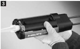
Mielőtt a tartályt a készülékbe helyezné, az (1) dugattyúszárat a (2) reteszélő gomb be nyomásával egyidejűleg teljesen vissza kell húzni (Lásd: 8. kép).
