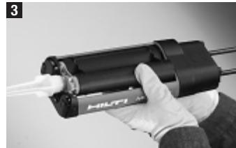
在灌注筒放入注射器之前，當壓下釋放杆(2)必須將推杆拉到底，可參看圖8。
