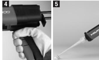
Den Betätigungshebel (4) durchziehen. Das Foliengebinde öffnet sich durch ein in der Zusammenführung integriertes Aufstech-system von selbst. Im Statikmischer wird das Vermischen der beiden Komponenten sichtbar. **Die Masse aus den ersten beiden Hüben jedes Gebindes (Mischervorlauf) ist nicht für die Befestigung geeignet und daher zu verwerfen.** Auch nach einem Mi-scherwechsel muss der Mischervorlauf verworfen werden (Bild 5). **1 Hub = Betätigungshebel bis zum Anschlag durchziehen.**
