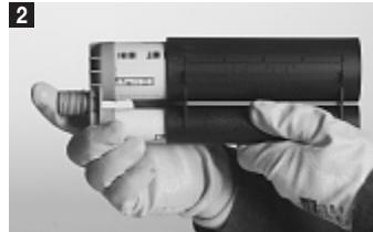
Introduceți ambalajul din folie (7) până la opriitor în casetă (6) și apoi însurubați amestecătorul static (8 sau 9).
