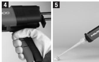
Pres aftrækkeren (4) i bund. Der prikkes automatiske hul på foliepatronen. Man kan se, at de to komponenter blandes, når de kommer ud gennem mixeren. **De to første pump mørtel, der kommer ud af en ny foliepatron er ikke egnet til brug og skal kasseres.** Efter udskiftning af mixer skal det første pump mørtel ligeledes kasseres (foto 5). Ved ét pump forstås, at aftrækkeren presses helt i bund én gang.
