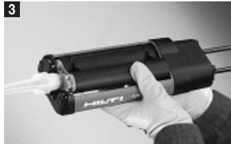
Înainte de asezarea casetei în aparat, barele de avans (1) trebuie să fie retrase complet cu acționare concomitentă a tastei pentru deblocare (2) (vezi imaginea 8).
