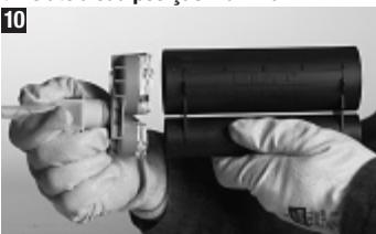
Os cartuchos vazios devem ser eliminados de acordo com a regulamentação aplicável. O suporte pode ser re-utilizável. Os pistões de pressão integrada voltam para a posição inicial quando um novo cartucho é inserido.
