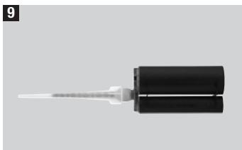
A embalagem de metal aberta, parcialmente usada, deve ser conservada no suporte com o bocal misturador acoplado. A massa adesiva no bocal misturador tornar-se-á seca após uma longa pausa. **O bocal misturador deve ser mudado antes de reiniciar o trabalho.**
