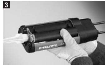
Prima di inserire il portacartuccie nella pompa tirare indietro al massimo i pistoni paralleli premendo sulla leva di rilascio.
