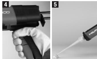
Stiskněte ovládací páčku (4). Fóliový zásobník se otevře automaticky propichovacím trnem, který je součástí směšovacího dílu. Ve statickém směšovači lze míchání obou složek pozorovat. **Hmota vycházející z každého zásobníku po dvojím prvním stisku ovládací páky není vhodná k upevnování (náběh směšování)** a proto je nutno ji odstranit do odpadu. Nabíhající směs je nutno odstranit také po výměně směšovače (obr. 5) 1 stisk = stisknutí ovládací páčky až na doraz.
