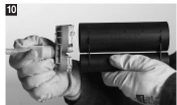
Ambalajele din folie care au fost golite de resturile de material se vor evacua ca deșeu conform prescripțiilor autorităților. Casetă poate fi încărcată din nou. Pistoanele de presiune integrate vor fi împinse înapoi în poziția inițială la introducerea nouului ambalaj din folie.
