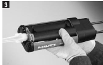
Pred vložením kazety do prístroja sa musia posúvacie tiahla (1) úplne vytiahnuť, pri súčasnom ovládani uvoľňovacieho tlačidla (pozri obr. 8).
