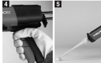
Нажмите на рычаг (4). Полиэтиленовая капсula откроется автоматически благодаря имеющимся в кассете прокалывающим шипам. Убедитесь, что два компонента раствора перемешались при прохождении через носик. **Смесь, поступающая из новой кассеты при первых двух нажатиях, не должна использоваться для анкерных креплений - ее нужно удалить.** Точно так же нужно удалить первую порцию смеси после замены носика (фото 5). Под нажатием понимается одно движение поршня до упора.
