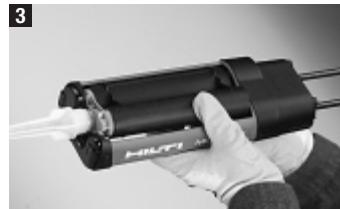
Před vložením kazety do přístroje musí být posuvný tyče (1) zataženy úplně dozadu při současném stisku uvolňovacího tlačítka (2), (viz obr. 8).
