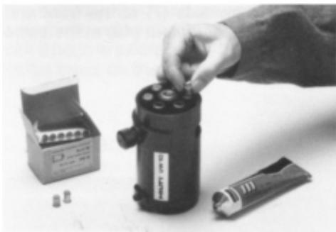
Die 6 Stk. Kartuschen (je nach Bedarf rot oder gelb) aus der Verpackung nehmen. Zur Abdichtung im Lauf sind diese mit Molycote 111 am Umfang dünn einzureiben.
