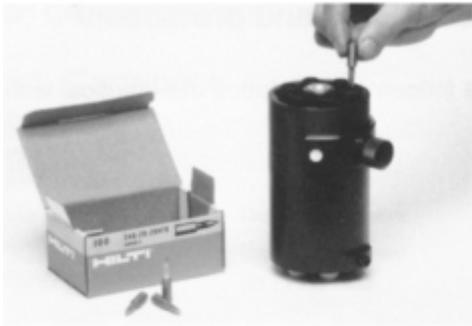
6 Stk. Gewindebolzen auf der gegenüberliegenden Lauföffnung beim Kartuschenlager, mit der Spitze voran hinfallen lassen. Wenn der Bolzen nicht bis zum Anschlag fällt, mit zweitem Bolzen nachschieben oder gegebenenfalls Kartuschenlager mit Bürste von Schmutzteilen befreien.
