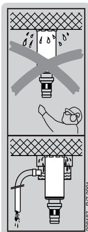
Pour des travaux au plafond, le système de récupération d'eau doit impérativement être utilisé avec une aspiration d'eau.
