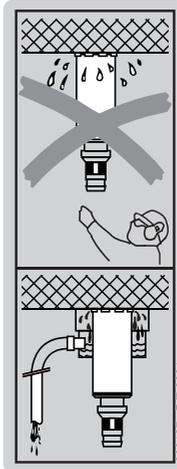
Mit dem Einsatz des Wasserfangsystems können Sie das Wasser gezielt abführen und dadurch starke Verschmutzung der Umgebung vermeiden. Zusammen mit einem Nasssauger kann das beste Ergebnis erzielt werden.
