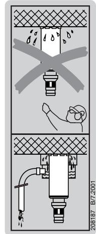
Für Arbeiten an Decken ist das Wasserfangsystem in Verbindung mit der Verwendung eines Nasssaugers zwingend vorgeschrieben.
