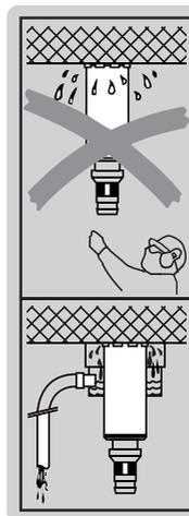
Empleando el sistema colector de agua puede evacuar el agua de forma dirigida y así evitar una fuerte contaminación del entorno. Se obtiene el mejor resultado si se utiliza junto con un aspirador en húmedo.
