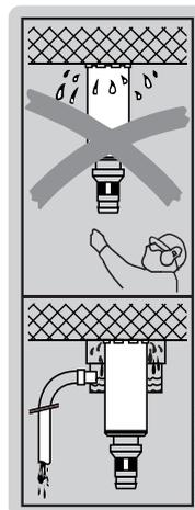
Pour tous travaux sous plafond, il est absolument nécessaire d'utiliser le système de collecteur d'eau branché à un aspirateur de liquides.
