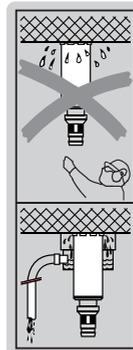
Pour tous travaux sous plafond, il est absolument nécessaire d'utiliser le système de collecteur d'eau branché à un aspirateur de liquides. Positionner la poignée latérale et la tête de rinçage/d'aspiration de manière à ne pas gêner le montage du système de collecteur d'eau. L'anneau de centrage et le joint doivent correspondre au diamètre de la couronne de forage diamantée.
