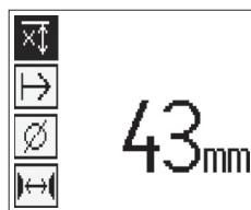
A nyílgombokkal válassza ki a korlátozott mélységmérés funkciót, majd nyomja meg a nyugtató gombot.
