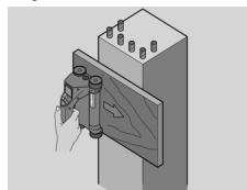
Použite tenkú, nekovovú podložku (napríklad drevo, polystyren, kartón...), ktorá presahuje cez hranu (hrany) stavebného objektu a skenujete podložku cez hranu, smerom von. Nezabudnite, že hrúbka podložky sa musí odpočítať od hodnôt nameraných pre hľbku. Hodnotu je možné zadať do počítačového softvéru a tu sa bude potom automaticky odpočítavať od všetkých nameraných hodnôt hľbky.
