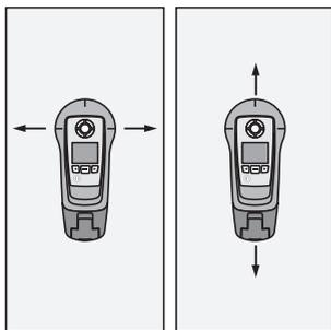
Afin d'obtenir de meilleurs résultats, l'appareil doit être déplacé selon la méthode de balayage (amples mouvements horizontaux et verticaux au-dessus de l'objet) Les quadrillages à l'écran indique la méthode de balayage. Si l'appareil est mis en marche pour la première fois, une animation apparaît dans la zone d'affichage afin d'expliquer comment déplacer l'appareil sur le support.
