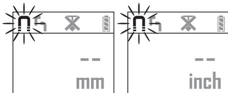
1. Mettre l'appareil en marche et tenir l'appareil en l'air et au moins à 30 cm (12 po.) de tout objet métallique ou éloigné du support à examiner.
