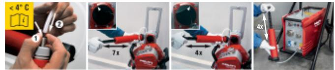
Entfernen des Kühlwassers aus Sägekopf und E-Box
