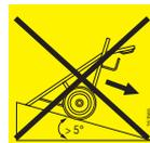
El carro de transporte puede rodar en superficies inclinadas.
