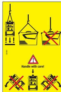
La unidad eléctrica puede ser elevada con grúa sólo desde los puntos diseñados a tal efecto. No trabaje bajo pesos suspendidos. Use sólo grúas testadas y aprobadas.
