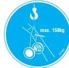
Tanto la cabeza como los carros de transporte pueden ser elevados con grúa sólo desde los puntos diseñados a tal efecto. Antes del transporte todos los elementos han de ser fijados con seguridad para prevenir caídas. No trabaje bajo pesos suspendidos. Use sólo grúas testadas y aprobadas.
