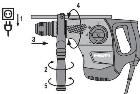
1. Tourner le dispositif de serrage (collier de serrage) sur la poignée latérale pour desserrer.
