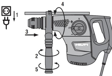
1. Ruotare l'impugnatura per allentare il sostegno (nastro di serraggio) dell'impugnatura laterale.
