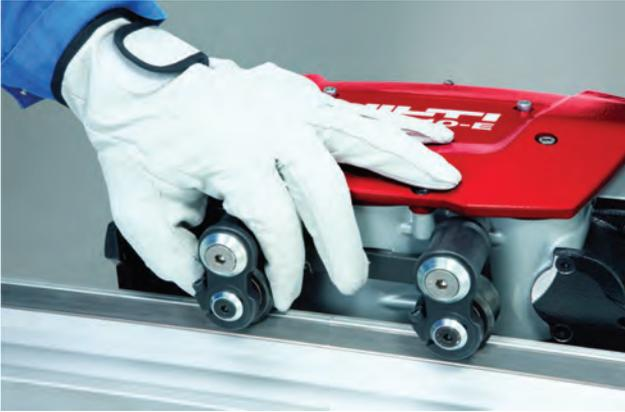
3. Coloque la excéntrica suavemente en el eje del rodillo hasta que el rodillo quede en contacto con el carril.
