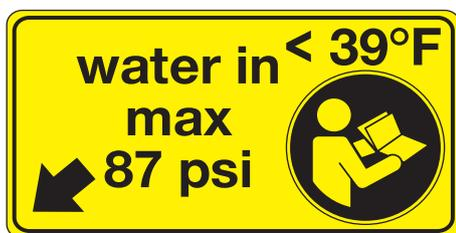
Para evitar daños, la presión del agua se debe mantener por debajo de 87 psi. Si existe riesgo de congelación en el circuito de refrigeración, vacíelo con aire comprimido como se describe.
