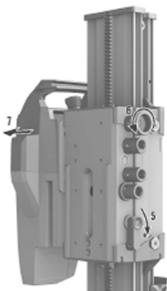
1. Extraia o cabo de ligação da unidade de alimentação da perfuradora para fora do tomada de ligação do perfurador diamantado.
