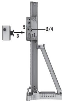
1. Bloquee el carro en el rail mediante el inmovilizador del carro.
