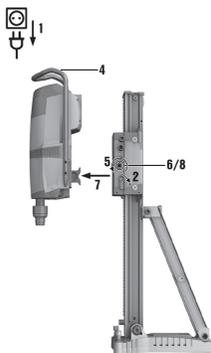
1. Bloquee el carro en el raíl mediante el inmovilizador del carro. Asegúrese de que esté bien fijado.
