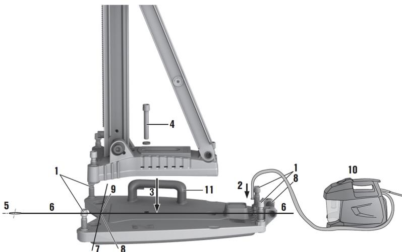
1. Desenrosque todos los tornillos de nivelación de manera que sobresalgan aprox. 5 mm por debajo de la placa base al vacío.
