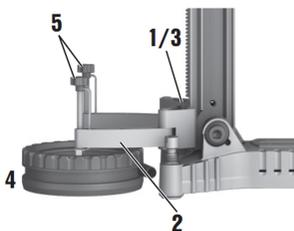
1. Afloje el tornillo del soporte en el lado frontal inferior del raíl.
