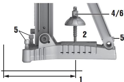
1. Coloque el taco para la placa base a unos 330 mm (13 pulgadas) del centro del taladro.
