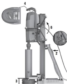
1. Conecte un dispositivo de aspiración y aire comprimido.
