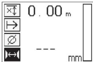
正しい直径がわかっていて、それを設定する必要があります。このためには、配筋ピッチが  $36 \text{ mm} \leq s \leq 120 \text{ mm}$  ( $1.41'' \leq s \leq 4.72''$ ) の範囲にある場合には、これを設定する必要があります。これは設計データから求めるか、継ぎ目開口部から求めるか、あるいはクイックスキャン探査により測定することができます。
