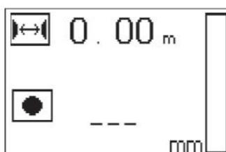
Wanneer de afstand bekend is, kan de waarde ook handmatig via de pijltjes toetsen worden ingevoerd.
