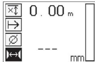
需預先知道正確的直徑並輸入。鋼筋間隔距離若在 $36 \text{ mm} \leq s \leq 120 \text{ mm}$  ( $1.41 \text{ in} \leq s \leq 4.72 \text{ in}$ ) 範圍內亦需輸入。此數值可從建築設計圖中獲得，透過將混凝土挖開一個通道來檢視鋼筋加以確認，或利用快速掃描偵測進行測量。
