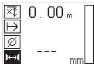
Le diamètre correct doit être connu et entré. De plus, la distance entre les fers doit être entrée si elle est comprise dans la plage  $36 \text{ mm} \leq s \leq 120 \text{ mm}$  ( $1,41'' \leq s \leq 4,72''$ ). Celle-ci se trouve sur des plans, ou peut être confirmée au moyen de fentes de contrôle ou encore être mesurée à l'aide de la détection à balayage rapide.
