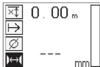
De juiste diameter moet bekend zijn en worden ingegeven. Bovendien moet de ijzerafstand worden ingevoerd wanneer deze in het gebied  $36 \text{ mm} \leq s \leq 120 \text{ mm}$  ( $1.41'' \leq s \leq 4.72''$ ) ligt. Dit kan worden gevonden in de bouwtekeningen of door sleuven bevestigd worden of met Quickscan-detectie worden gemeten.
