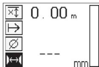
Se debe conocer e introducir el diámetro correcto. Además, debe introducirse la distancia del hierro si se encuentra en un rango de  $36 \text{ mm} \leq s \leq 120 \text{ mm}$  ( $1.41'' \leq s \leq 4.72''$ ). Dicha distancia se puede extraer de los datos del plano, confirmarse mediante la apertura de ranuras o medirse con la detección Quickscan.
