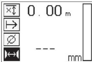
Диаметр должен быть известен. Его нужно ввести. Кроме того, необходимо ввести расстояние между стержнями, если оно находится в диапазоне  $36 \text{ mm} \leq s \leq 120 \text{ mm}$  ( $1,41'' \leq s \leq 4,72''$ ). Его можно узнать из данных, указанных в плане, проверить через имеющиеся отверстия или измерить в режиме Quickscan Detection.
