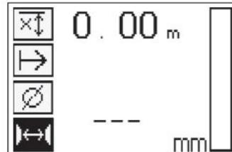
Der richtige Durchmesser muss bekannt sein und eingegeben werden. Zudem muss der Eisenabstand eingegeben werden, wenn er im Bereich  $36 \text{ mm} \leq s \leq 120 \text{ mm}$  ( $1.41'' \leq s \leq 4.72''$ ) liegt. Dies kann entweder den Platten entnommen werden, oder durch Schlitzöffnungen bestätigt werden oder mit Quickscan Detektion gemessen werden.
