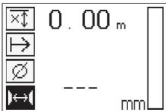
Den korrekta diametern måste vara känd och angiven. Dessutom måste järnavståndet ange om det ligger inom intervallet  $36 \text{ mm} \leq s \leq 120 \text{ mm}$  ( $1.41'' \leq s \leq 4.72''$ ). Detta kan tas från plandata, bekräftas genom slitsöppningar eller mätas med Quickscan-detektering.
