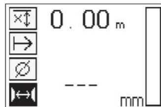
O diâmetro correcto tem de ser conhecido e previamente introduzido. Além disso, deve introduzir-se a distância entre ferros quando esta se situar dentro do intervalo  $36 \text{ mm} \leq s \leq 120 \text{ mm}$  ( $1,41'' \leq s \leq 4,72''$ ). Esta pode ser extraída dos dados da planta, confirmada através da abertura de roços ou medida com detecção Quickscan.
