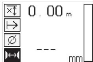
정확한 직경을 알고 입력해야 합니다. 이 외에도 철근 간격을 입력해야 합니다(철근이  $36 \text{ mm} \leq s \leq 120 \text{ mm}$  ( $1.41" \leq s \leq 4.72"$ ) 사이에 있을 경우). 철근 간격은 계획 데이터 또는 구멍을 통해 계산하거나 퀵 스캔 탐지로 측정할 수 있습니다.
