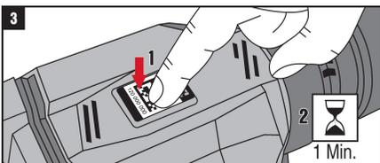
Presione la Smart Label con la parte blanda de la mano o con un rodillo aplicando una presión uniforme. Una mayor presión incrementa la adherencia de la Smart Label.
