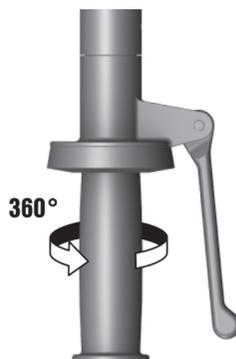
Das Griffstück ist für eine jederzeit komfortable Arbeitshaltung drehbar.
