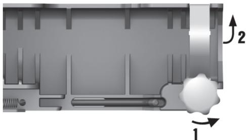
Öffnen Sie den Haltebügel durch Losdrehen der Rändelschraube.
