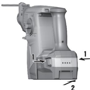
1. Premere i tasti di sbloccaggio della batteria.
