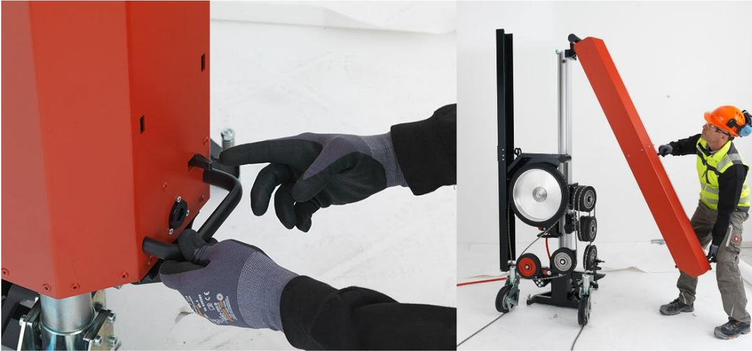
4. 拆下锯绳卷绕装置护罩。
