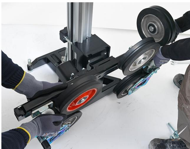
1. 将锯绳吊具安装到底板支架的顶部位置。
