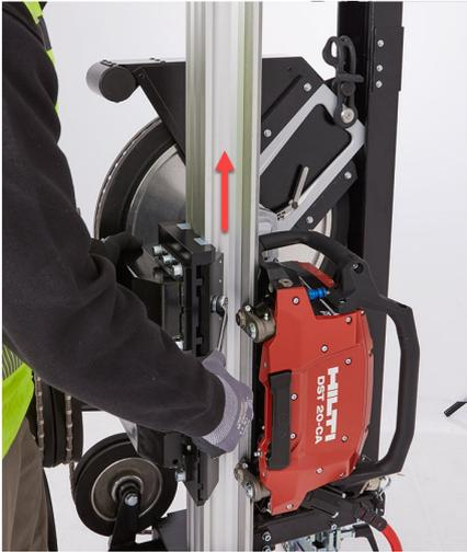
6. 拧松夹紧螺钉后，将顶部的卷绕滑轮组件沿导轨向上滑动，直至将金刚石锯绳拉紧。
