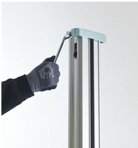
1. 将终点止挡安装到导轨上。
