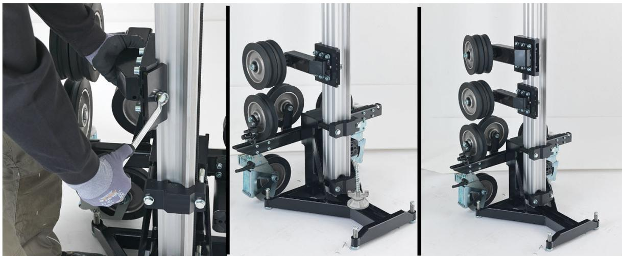
1. 打开锯绳卷绕滑轮夹紧板，然后，将锯绳卷绕底轮安装到导轨上。
