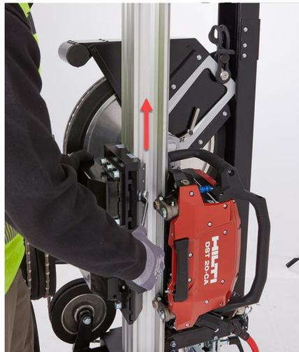
5. 将锯绳卷绕装置的顶轮拧松并沿导轨向上滑动滑轮，直至将金刚石锯绳拉紧。
