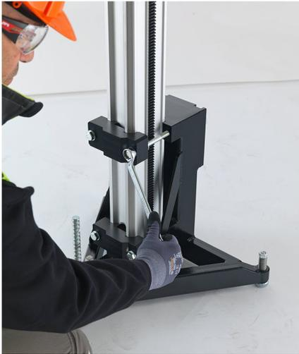
1. 将导轨滑到底板上的支架中。
