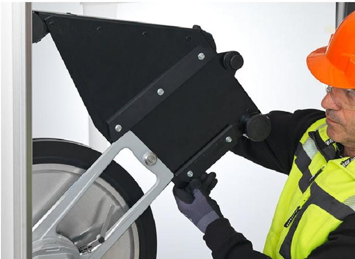
1. 将防护罩推到锯削头上的锯片防护罩支架上。
