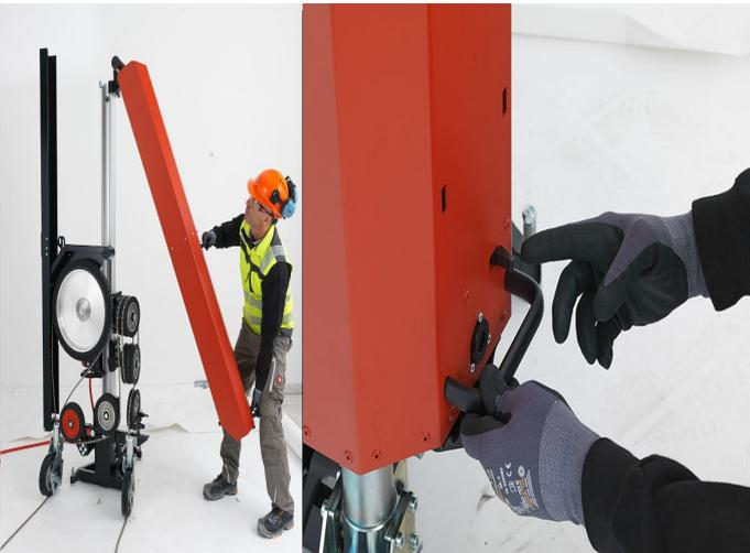
1. 从下方将锯绳卷绕装置护罩推到支架上，直至推不动为止。
