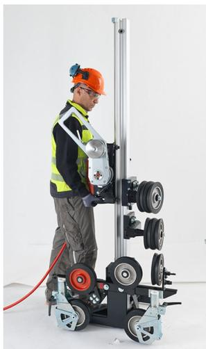
4. 打开锯削头上的锁销，然后将锯削头安装到导轨上。
