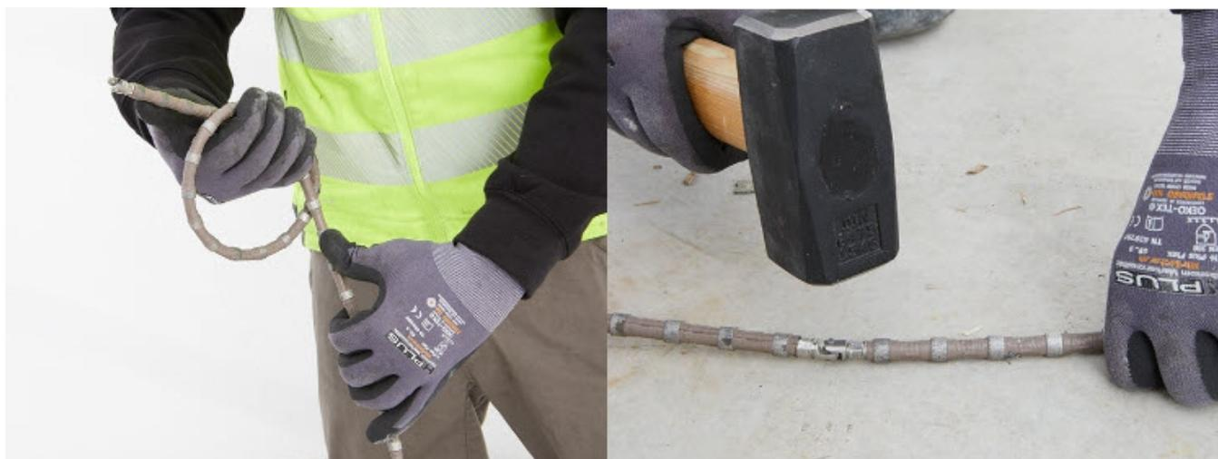
2. 为防止非圆化磨损，请将金刚石锯绳每米按逆时针方向旋捻 1-1.5 圈。
