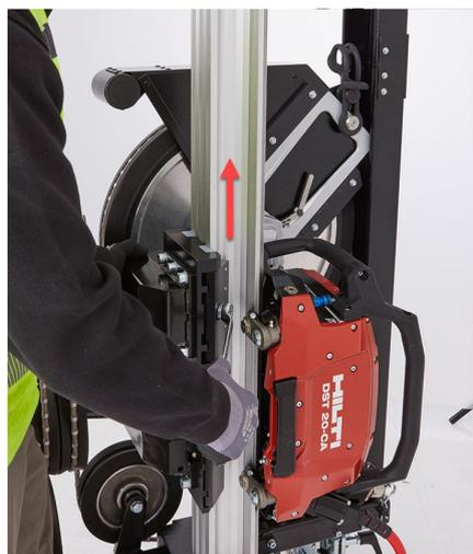
5. Allentare il rullo superiore del magazzino del filo e spingere verso l'alto quest'ultimo sul binario, finché il filo di taglio diamantato non è teso.
