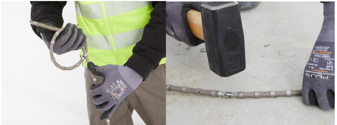
2. Al fine di evitare usure irregolari, ruotare il filo diamantato 1 - 1,5 volte al metro in senso antiorario.
