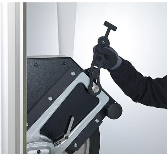
2. Fissare la copertura di protezione con un gommino di serraggio sul supporto di protezione della lama.
