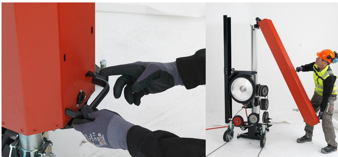
4. Smontare la copertura del magazzino del filo.
